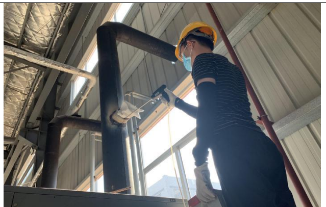
蒸汽机废气采样
